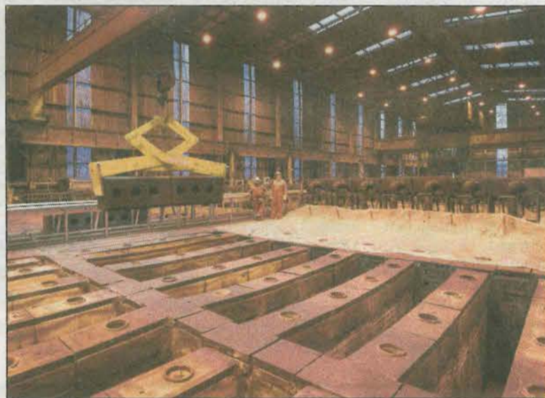
■ Twee anodes (koolstofblokken) worden met een hulpkraan opgepakt om in de vuurkamer te worden geplaatst.
